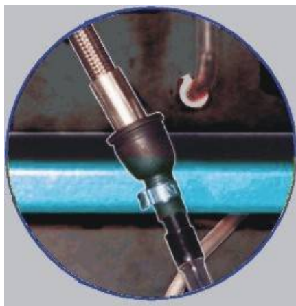
Figuur 14. Verbinden van de lekttestadapter
