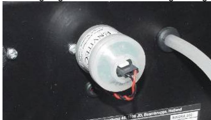
Figuur 16. De zuurstofsensoren van de MS810
