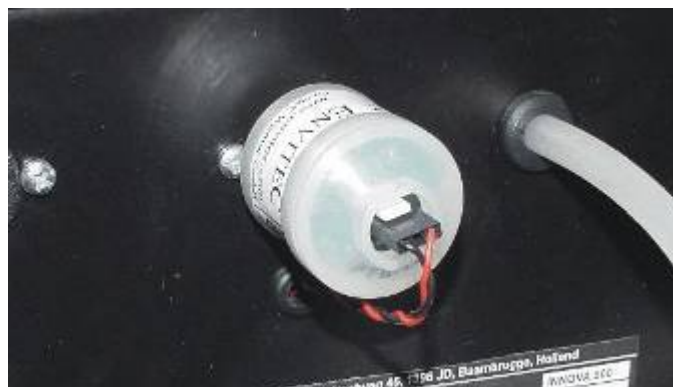
Figuur 16. De zuurstofsensor achterop de tester
