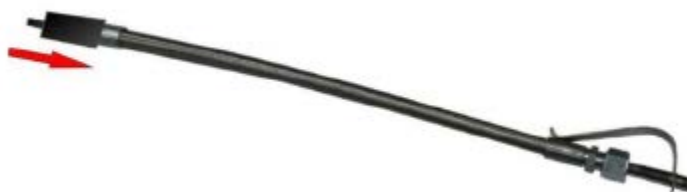
Figuur 11. Plaats de lectestadapter op de sonde.
