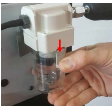
Figuur 12. Druk de clip omlaag.
