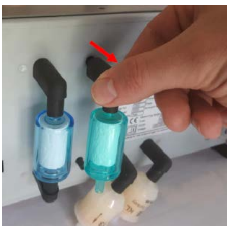
Figuur 15. Trek de filterhouder los.
