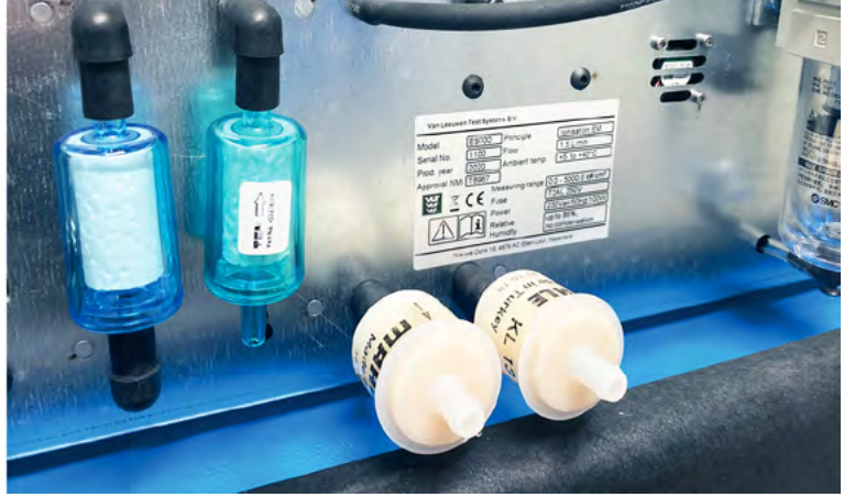
foto: Aan de achterzijde het pompfilter, het HEPA filter en het condensatiefilter. De filters moeten maandelijks worden gecontroleerd en eventueel worden vervangen. Dit is eenvoudig zelf te doen.
