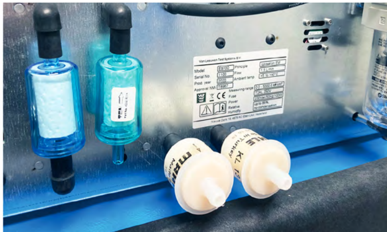
foto: Aan de achterzijde het pompfilter, het HEPA filter en het condensatiefilter. De filters moeten maandelijks worden gecontroleerd en eventueel worden vervangen. Dit is eenvoudig zelf te doen.
